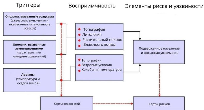
Рисунок 2 - Схематический подход к оценке опасности возникновения оползней
