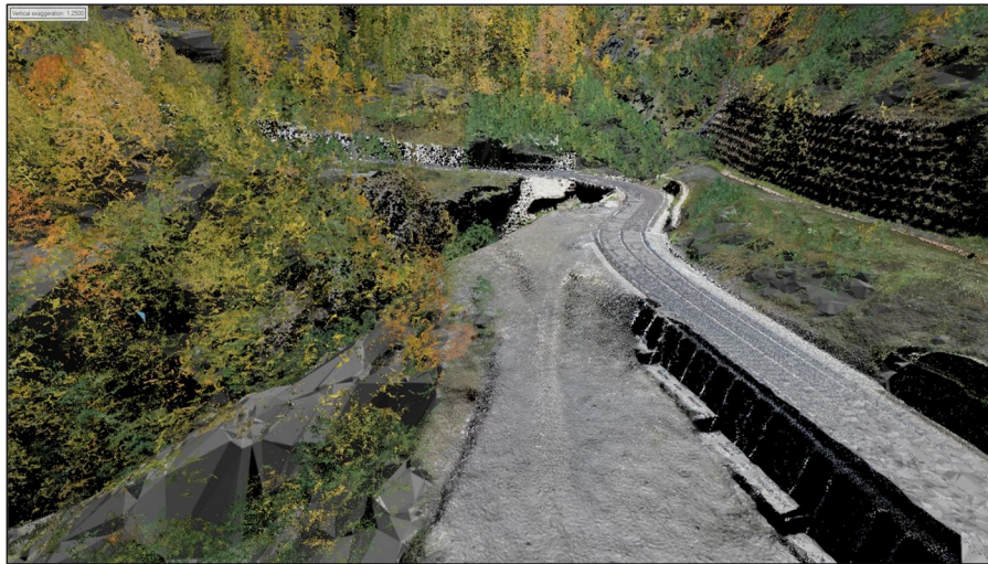
Рисунок 3 - Фрагмент ЦММ, созданной по данным ВЛС и АЭС DOI: https://doi.org/10.60797/GEO.2025.2.2.3
