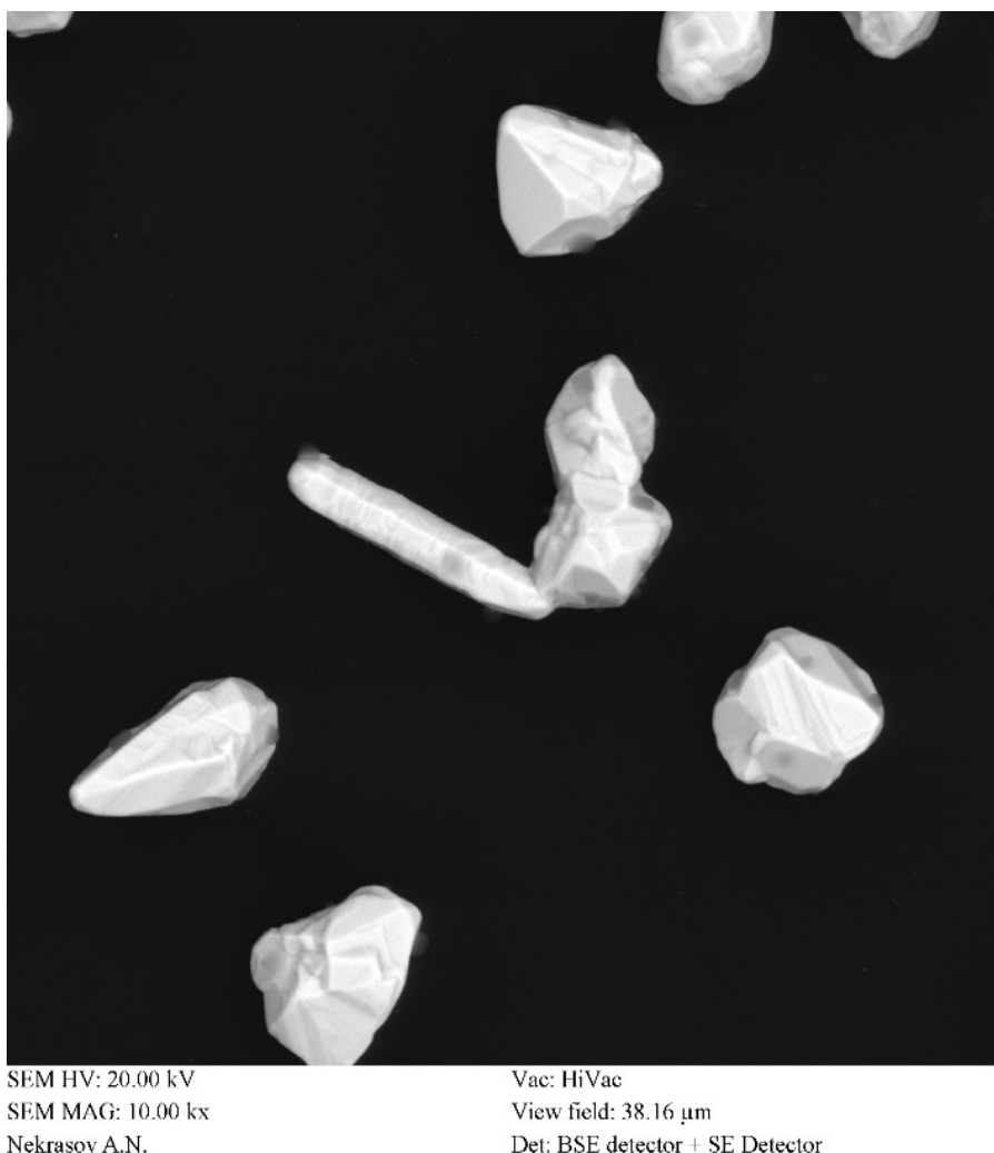
Рисунок 5 - Кристаллы золота, полученные в результате взаимодействия хлоридных растворов Au с H 3 PO 4 при комнатной температуре
